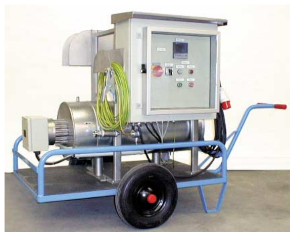
Fahrbarer Stickstoff-Erhitzer 7,5 kW, 290 °C, 4,5 bar für Tanktrocknung Portable nitrogen heater 7,5 kW, 290 °C, 4,5 barg for tank drying
